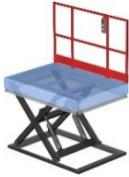
Geländer sind immer dann notwendig, wenn Personen mehr als 500 mm von der Plattform fallen können. Die Ausführung der Geländer erfolgt gemäß den Vorgaben der EN15070-1 mit 1100 mm Höhe und steifer Knie- und Fußleiste. Bei COLUMBUS McKINNON Hubtischen sind die Geländer aus robusten 50x50x3 Stahlprofilen gefertigt. Um Sicherheitsabstände einzuhalten, sind die Geländer meist 120 mm von den Plattformkanten abgesetzt. Plattformaufbauten mindern die nutzbare Plattformoberfläche!
