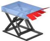
Segmentierte Überladeklappen stellen eine effektive Art dar, um den Spalt zwischen Fahrzeug und Hubtisch zu überbrücken. Die übliche Segmentaufteilung beträgt ca. 400x400 mm. Die Maximale Tragfähigkeit eines einzelnen Segmentes beträgt 750 kg. Bei Hubhöhen kleiner als 1.600 mm kann die Seite zum Fahrzeug hin ohne absichernde Geländer oder Sicherheitstüren offen bleiben.
