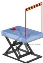
Eine Portalbrücke wird als Sicherheitsgeländer an der zur Rampe angrenzenden Hubtischseite eingesetzt und sichert den entsprechenden Rampenabschnitt vor Stürzen wenn der Hubtisch vollständig gesenkt wurde. Die lichte Durchfahrthöhe beträgt je nach Rampenausführung ca. effektiver Hub + 1100 mm.
