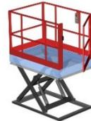
Eine Sicherheitstür wird meistens mit einem Geländer kombiniert und sichert die Seite ab, über die in der Be- oder Entladevorgang stattfindet. Oft wird eine Sicherheitstür z.B. auch eingesetzt, wenn der Hubtisch als Arbeitsbühne genutzt wird. Die Tür verfügt über eine Sicherheitsverriegelung, die nur dann öffnet, wenn sich der Hubtisch in einer sicheren Stellung befindet.
